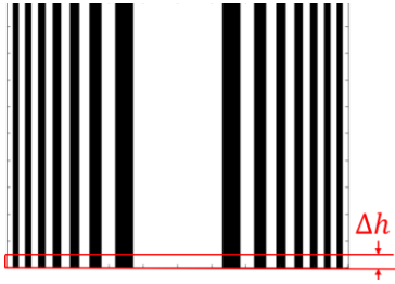
图 1 长条波带片中窄条单元的构建
